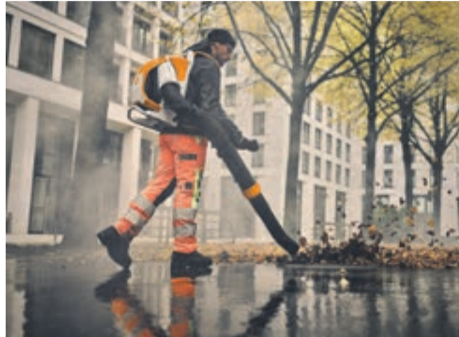
De machines zijn uitgerust met het Stihl Noise Reduction System, dat storende frequenties en piekgeluiden wegneemt.
