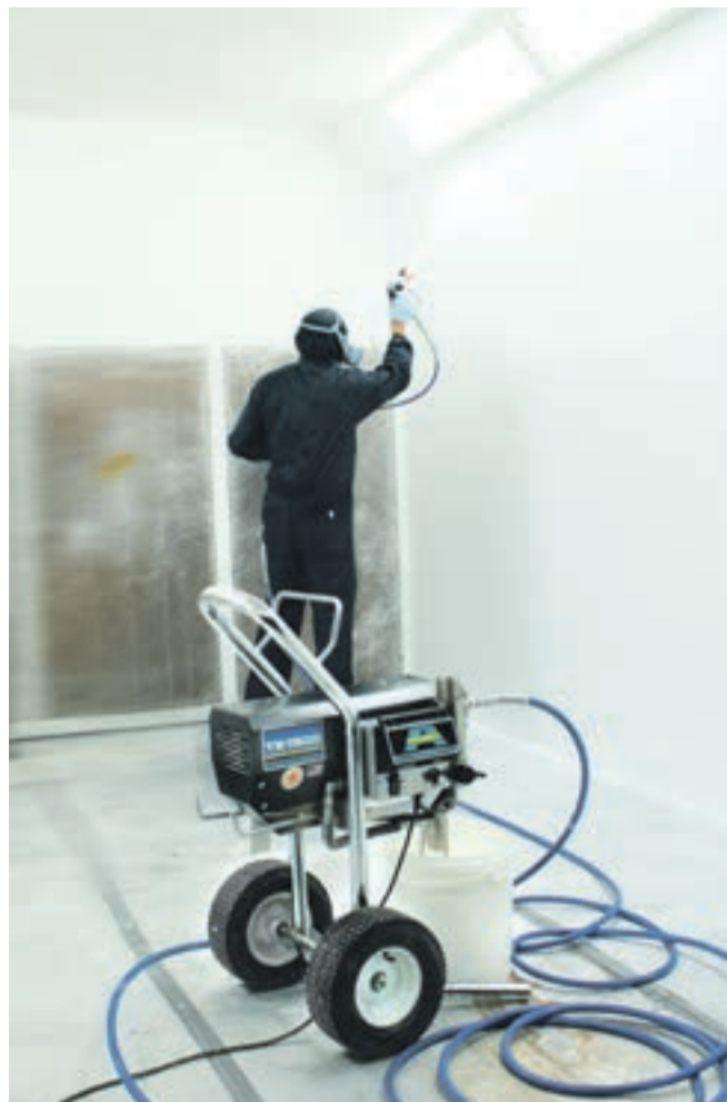
Een goed beschermde cabine blijft niet alleen langer schoon, maar zorgt ook voor een stabiel spuitproces. Optimale lichtreflectie verkleint de kans op afkeur en ondersteunt een constante kwaliteit.
