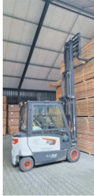
De elektrische heftrucks van het type B35X-7 Plus zijn uitgerust met lithium-ion accu's en hebben een hefvermogen van 3500 kilo.
